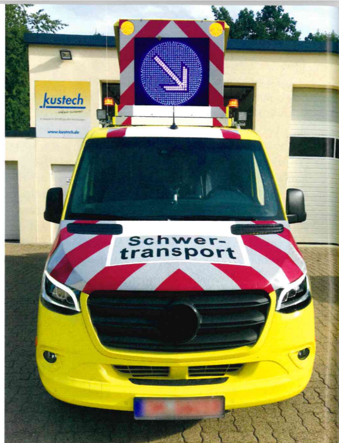
Mit einer Kustech-Matrix geht es auch bei nach vorne gestellter Matrix mit 120 km/h über die Straße.
