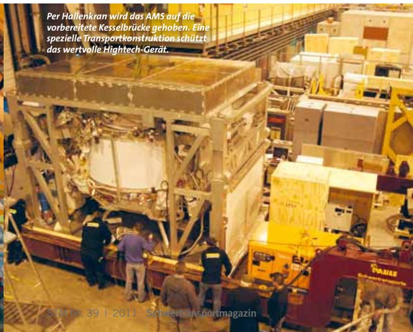
Per Hallenkran wird das AMS auf die vorbereitete Kesselbrücke gehoben. Eine spezielle Transportkonstruktion schützt das wertvolle Hightech-Gerät.
