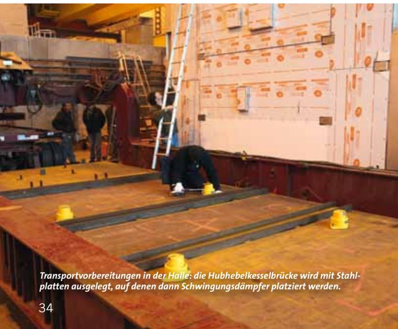
Transportvorbereitungen in der Halle: die Hubhebelkesselbrücke wird mit Stahlplatten ausgelegt, auf denen dann Schwingungsdämpfer platziert werden.
